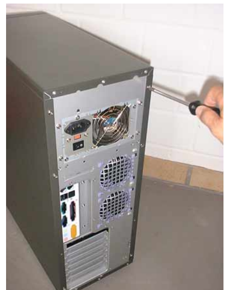
Austauschen der originalen Schrauben gegen die mitgelieferten Gehäuseschrauben (Aufgrund der Magnetstreifenstärke müssen Schrauben mit einem flachen Kopf verwendet werden) Please remove the original screws and use the screws contained in this shipment
